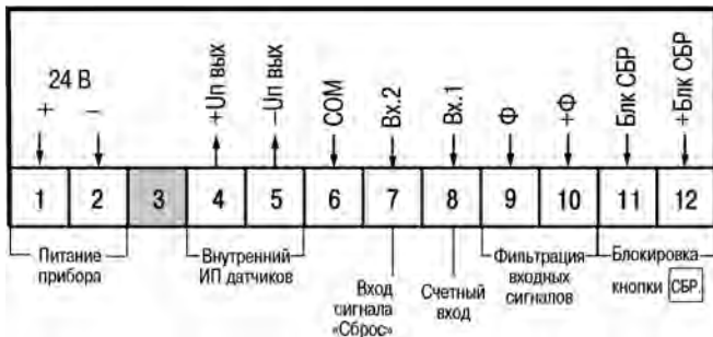
Рисунок 5.1 – Назначение контактов клеммника
